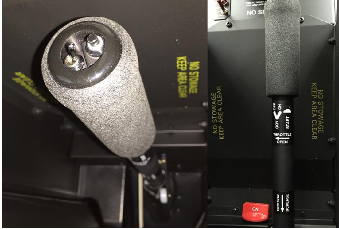
Şekil 8. Solda R44 II Governor ve Starter Anahtarları, sağda Gaz Kolu üzerinde çalışma pozisyonları
