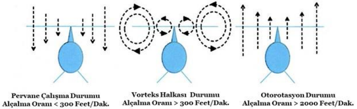
Şekil 9. Helikopter Çalışma Durumlarında Ana Rotor Diski İçinden Geçen Hava Akımları
