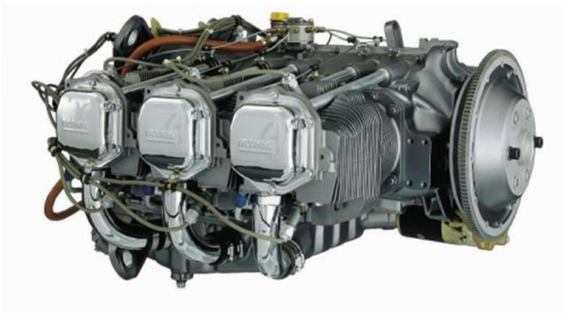
Altı silindirli ve yakıt enjeksiyonlu Lycoming IO-540 Motoru
